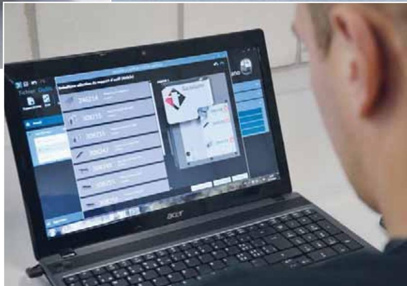
Übertragung des Programms auf die Maschine über WLAN oder einen USB-Stick können immer noch Anpassungen vorgenommen werden. Die Werkstückprogramme sind mit den Offsets gespeichert. Bei der Übernahme des Programms für eine neue Einrichtung verfügt der Bediener sofort über sämtliche Informationen und die richtigen Einstellungen.
