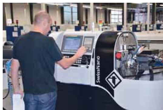
TISIS simplifica enormemente la programación de la máquina SwissNano y, según palabras del responsable, es uno de los puntos fuertes de la máquina.
