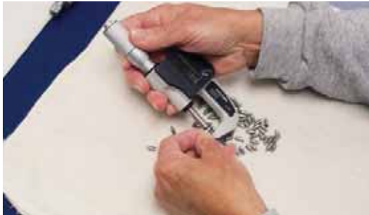
Ingenieros de control de calidad utilizando un micrómetro digital para comprobar las tolerancias mínimas de una pieza realizada en una de nuestras SwissNano.
