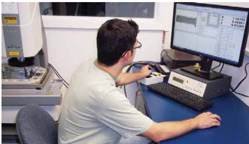
Uno de nuestros 4 ingenieros de control de calidad utilizando un sistema de visión láser para comprobar las dimensiones de una pieza realizada en nuestra EvoDeco 32.
