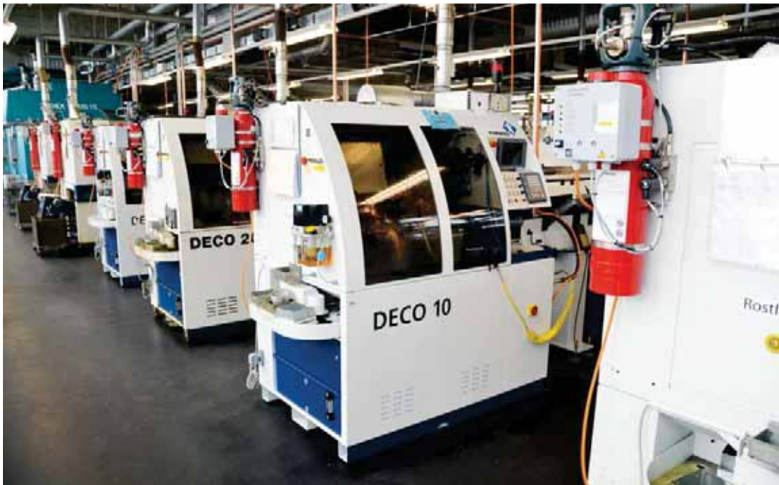
Tras 15 años de uso intensivo, la revisión borra los estragos del tiempo y las Deco 10 parecen las originales de 1997.
