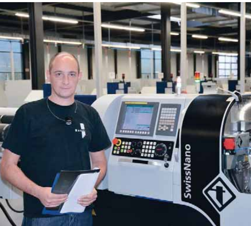
TISIS simplifica enormemente la programación de la máquina SwissNano y, según palabras del responsable, es uno de los puntos fuertes de la máquina.
