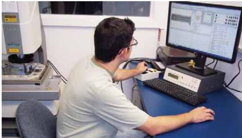
Un de nos 4 ingénieurs de contrôle qualité utilisant un système de vision laser pour contrôler les dimensions d'une pièce fabriquée sur notre EvoDeco 32.
