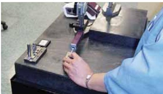
Ingénieur de contrôle qualité utilisant un profilomètre pour contrôler la finition du diamètre intérieur d'une pièce fabriquée sur l'EvoDeco 32.
