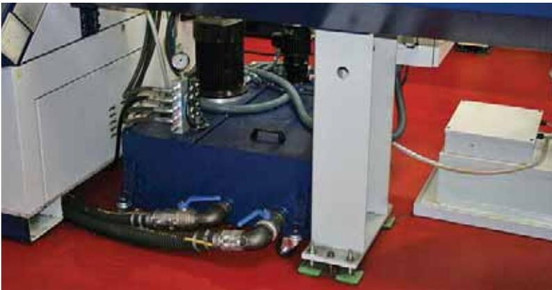
Pompe HPC rétrofitée sur un Tornos Deco.
