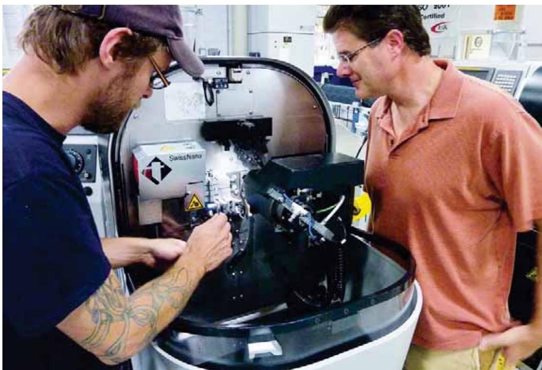
Il nostro responsabile CNC e il nostro direttore di fabbrica fissano un blocco inclinato a un angolo di 7 gradi in una delle nostre nuove SwissNano per fabbricare un particolare specifico nei settori della medicina e dell'elettronica.
