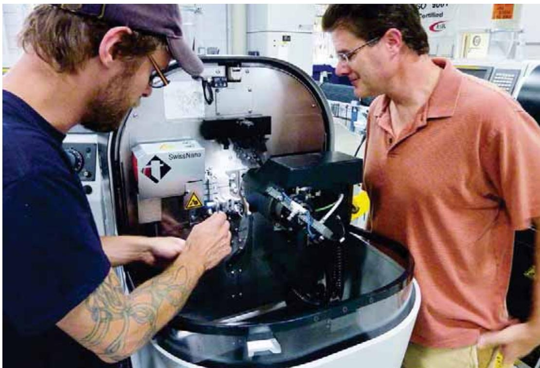
Nosso gerente de CNC e gerente de planta fixam um bloco de ângulo de 7 graus em uma de nossas SwissNanos para fabricar uma peça para clientes dos setores médico e eletrônico.
