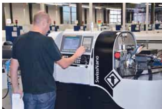
Programmeringen av maskinen SwissNano blir mycket enklare genom att använda TISIS, och enligt Christophe Goullier är det en av maskinens starka sidor.
