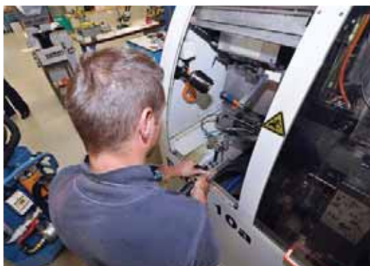
Beroende på material och processer rengörs maskinerna vid exakt definierade intervaller; som en del i denna process filtreras skäroljan mycket fint och fylls på. Detta sker individuellt, eftersom det inte finns något centralt försörjningssystem.
