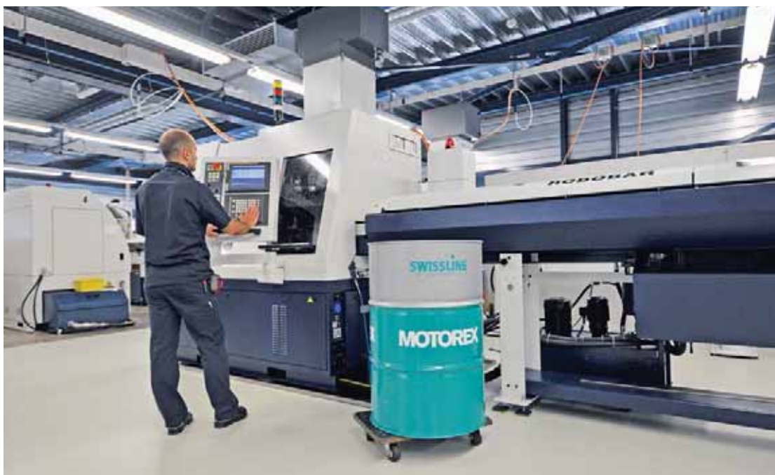
Lokalerna, som är luftkonditionerade till exakt 23° C och optimalt ventilerade ger en mycket angenäm arbetsmiljö och i samma, konstanta klimathållanden är de komplicerade bearbetningsprocesserna alltid garanterade att vara reproducerbara.
