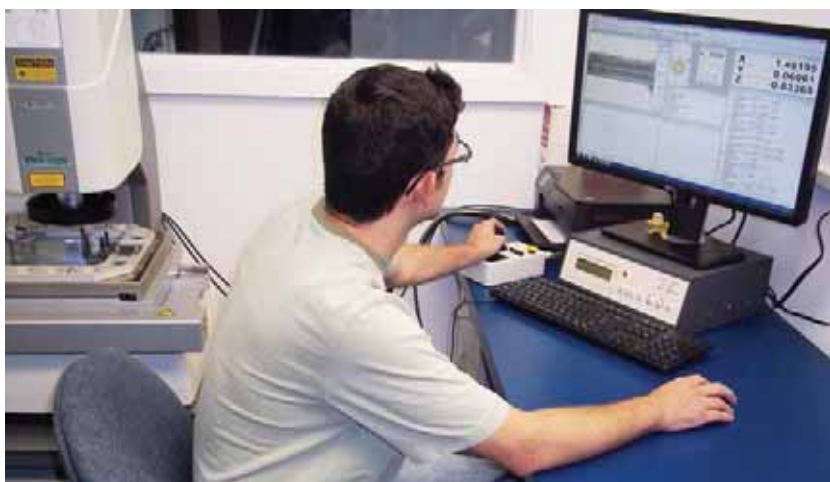
En av Petrons 4 kvalitetskontrolltekniker använder ett laservisionssystem för att kontrollera en detaljs dimensioner från en detalj tillverkad i EvoDeco 32.
