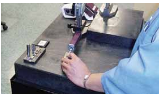
Kvalitetskontrolltekniker använder en Profilometer för att kontrollera ytfinheten på en detaljs invändiga diameter tillverkad i EvoDeco 32.
