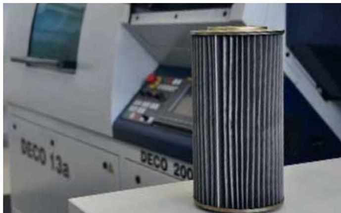
Avec l'huile de coupe Ortho NF-X d'une viscosité de la classe ISO VG 15, la chaleur peut être éliminée efficacement et même la plus petite des particules d'usure de titane est filtrée facilement. Le liquide ne colle donc pas aux pores du filtre.
