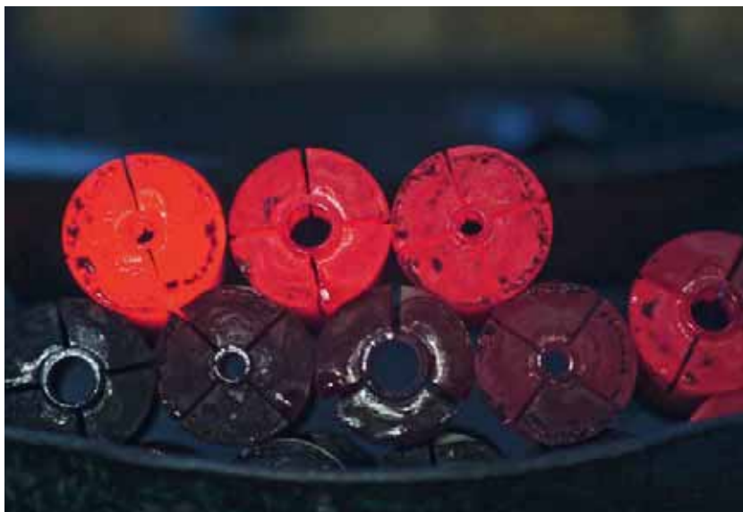
Pinze in corso di raffreddamento. Molte sono le attività che si svolgono nelle officine della Società Walter Dünner SA.
