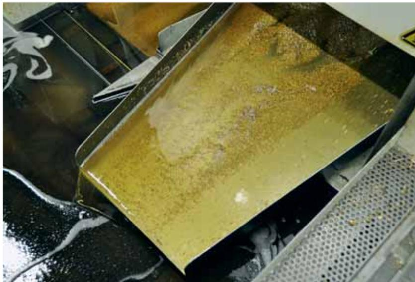
Bei BEC fallen im Produktionsprozess tonnenweise Späne an. Deren Recycling und die Rückgewinnung des ausgetragenen Schneidöls sind für die Kalkulation massgebend.
