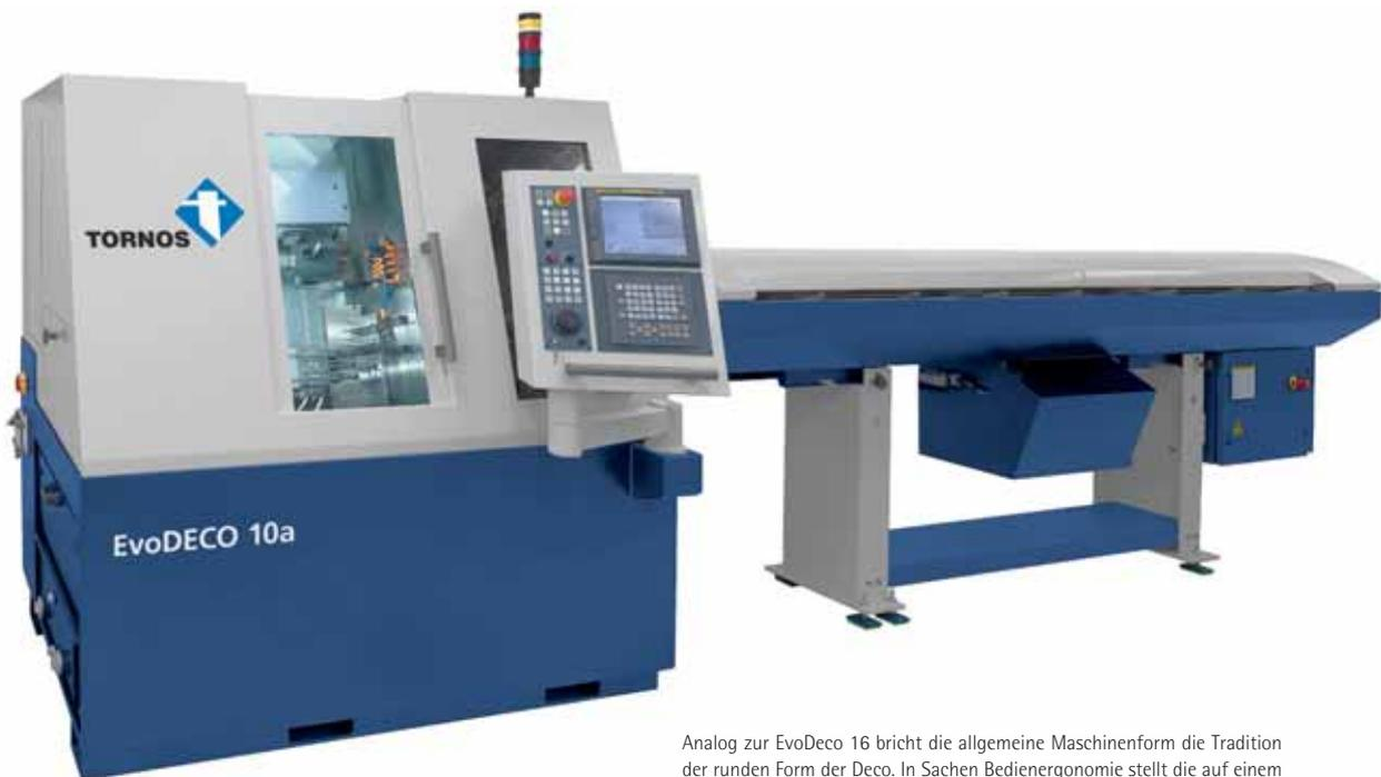
Analog zur EvoDeco 16 bricht die allgemeine Maschinenform die Tradition der runden Form der Deco. In Sachen Bedienergonomie stellt die auf einem Gelenkarm montierte Steuerung einen grossen Schritt nach vorn dar.
