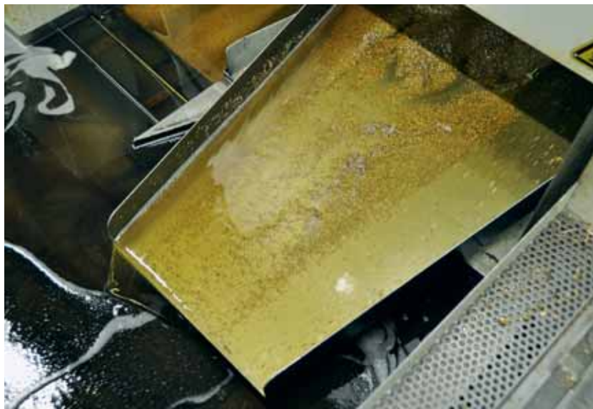
En BEC se generan durante la producción toneladas de virutas. El reciclaje de las virutas y la recuperación del aceite son determinantes para el cálculo.
