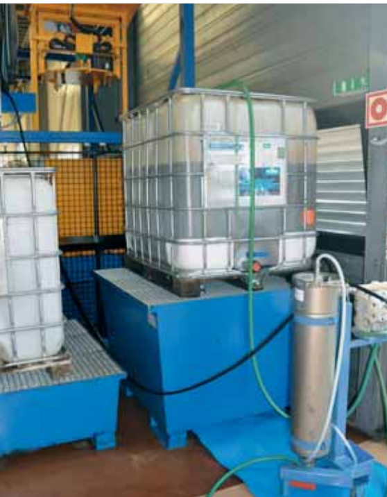
El aceite recuperado se limpia por medio de un filtro y se devuelve a las máquinas-herramienta después de añadirle una dosis de aceite nuevo.
