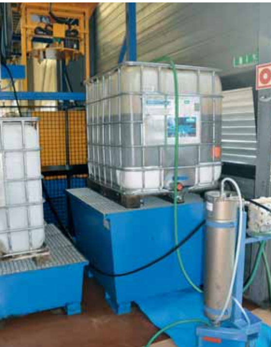
L'huile récupérée est purifiée grâce à un système de filtration, puis renvoyée vers les machines-outils avec de l'huile neuve.
