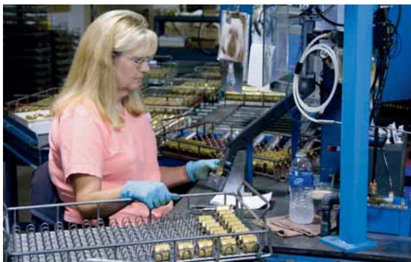
L'une des machines «maison» utilisées pour assembler les cadenas WB. La société est toujours prête à automatiser quand cela présente une utilité pratique. Toutefois, elle est convaincue que l'élément humain est indispensable à son fonctionnement.
