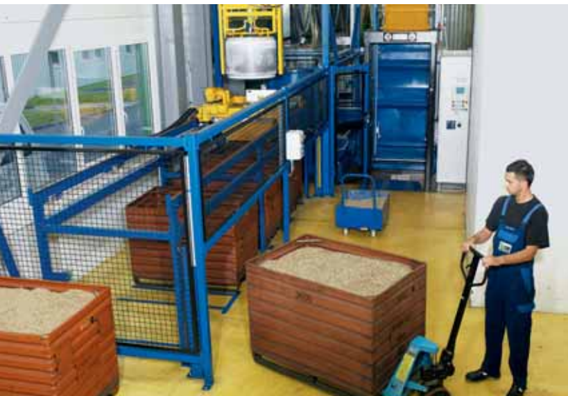
Le passage à une huile de coupe unique a simplifié la récupération de l'huile, qui s'effectue désormais grâce à une centrifugeuse à copeaux entièrement automatique.
