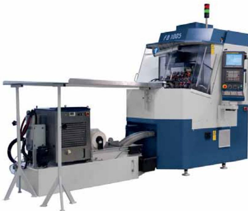
Progettata per garantire delle fresature di precisione negli acciai tenaci così come nei metalli nobili, essa è dotata di una slitta X guidata su binari presolleccati ed è mossa tramite vite a sfere. La slitta X supporta l'asse verticale Y formato da un prisma massiccio in ghisa sul quale si sposta un manicotto rettangolare. Guidato su 4 binari presolleccati, anch'esso viene mosso tramite una vite a sfere e consente il montaggio di un blocco munito di mandrini frontali, laterali e verticali.
