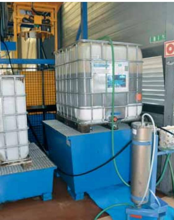
L'olio recuperato è purificato per mezzo di un sistema di filtrazione e, in seguito, rinviato verso le macchine-utensili unitamente a dell'olio nuovo.
