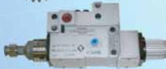
Multiplicateur de vitesse angulaire à 90°. Capacité de serrage 5 mm. 15 000 t/min
