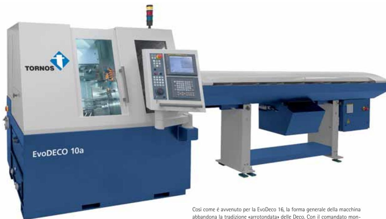
Così come è avvenuto per la EvoDeco 16, la forma generale della macchina abbandona la tradizione «arrotondata» delle Deco. Con il comando montato su di un braccio articolato, l'ergonomia della regolazione fa un salto in avanti.
