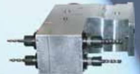
Tête polyvalente de perçage fraisage pour gros usinages avec réducteur de vitesse. Utilisable avec ou sans contre-palier.
