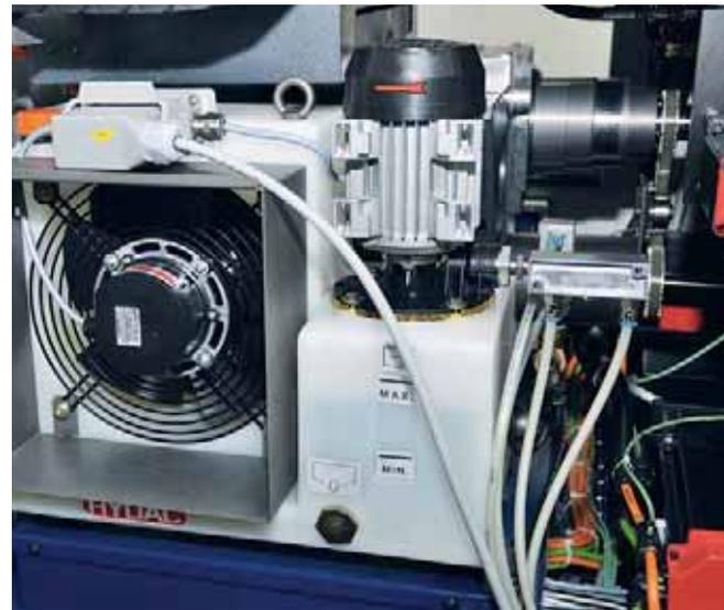
El sistema de refrigeración completo tiene capacidad para hasta 20 litros de refrigerante para husillos. El enfriador de aceite integrado mantiene la temperatura del líquido siempre dentro del margen definido. Distintos sensores integrados controlan y protegen el sistema.
