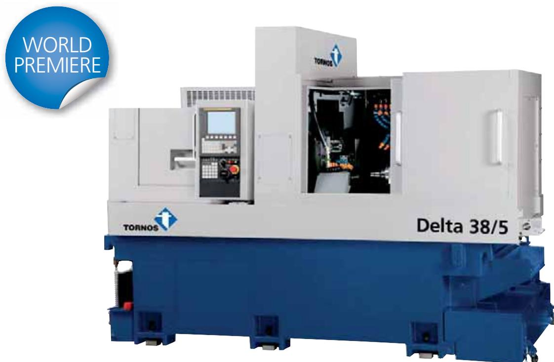
El torno Delta 38/5 pretende ser a la vez una puerta de entrada al mundo de Tornos, pero también un paso a diámetros mayores. El torno tiene capacidad para mecanizar piezas de 35 mm de diámetro. El diámetro máximo alcanza los 38 mm gracias a una preparación de barras. Dotado con 5 ejes lineales, dos ejes C y dos sistemas de herramientas independientes Delta 38/5 admite hasta 31 herramientas.
