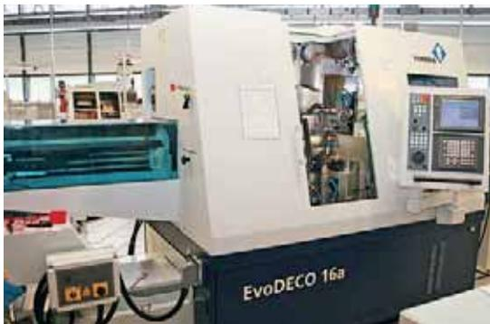
Como indica la escotadura claramente visible por encima del área de trabajo, esta parte de la carcasa está totalmente integrada en la puerta corredera. Una característica muy valorada por los operarios de mecanizado.
