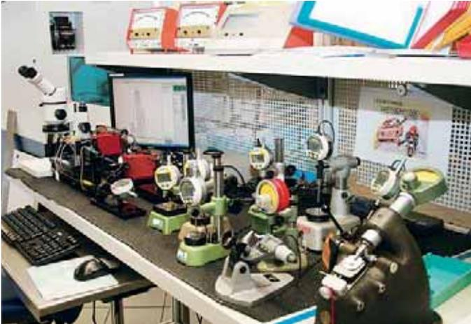
El operario de mecanizado dispone de todo un arsenal de instrumentos de medida directamente al lado del torno, para poder comprobar de manera segura y eficiente la calidad de las piezas de torneado.
