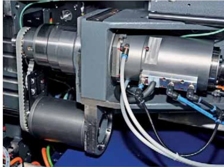
Con su potente diseño, el husillo motorizado síncrono constituye un importante factor de éxito. Así es: las dos tuberías transparentes de alimentación para la refrigeración de los husillos.
