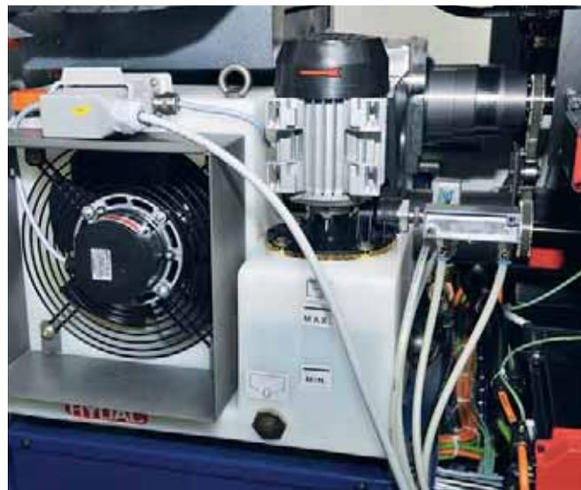
L'ensemble du système de refroidissement comprend jusqu'à 20 litres de liquide de refroidissement pour broches. Le refroidisseur d'huile intégré maintient toujours la température du fluide dans la plage définie. Plusieurs capteurs intégrés permettent en l'occurrence de surveiller et protéger le système.
