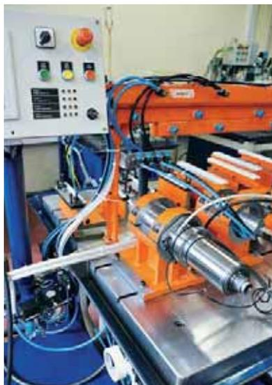
Avant le montage, chaque broche est testée et «rodée». Les résultats sont conservés dans un rapport d'essais et classés selon la broche correspondante. Les positions de broches sont lubrifiées à la graisse.
