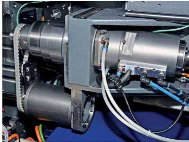
Avec son design performant, la broche du moteur synchrone installée est un facteur de succès important. A voir: les deux circuits d'alimentation transparents pour le refroidissement des broches.
