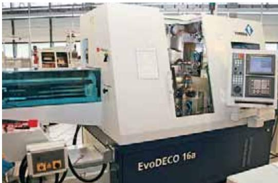
L'intégration de la partie supérieure de la machine dans les portes coulissantes dégage complètement la zone d'usinage. Cette caractéristique est très appréciée par les personnes chargées du décolletage.
