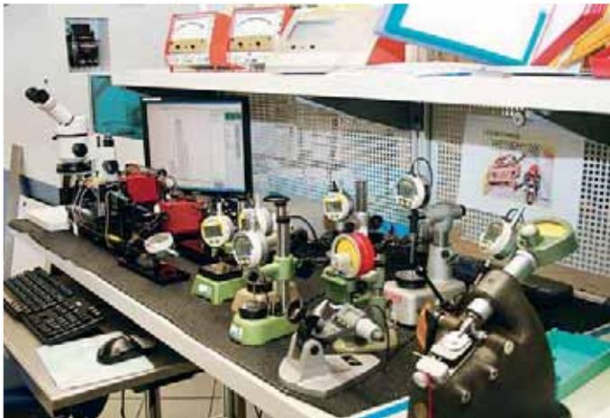
E' affianco ai torni automatici che la persona incaricata della tornitura, ha voluto tutta una schiera di strumenti di misurazione per verificare in totale sicurezza ed efficacia la qualità dei particolari torniti.
