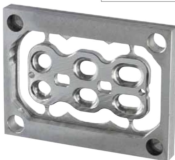
Un tipico particolare fresato per la lavorazione simultanea su 5 assi in una macchina Almac CU 1007. Le viti corrispondenti potrebbero essere realizzate, ad esempio, su un tornio Tornos MultiAlpha 8x28.
