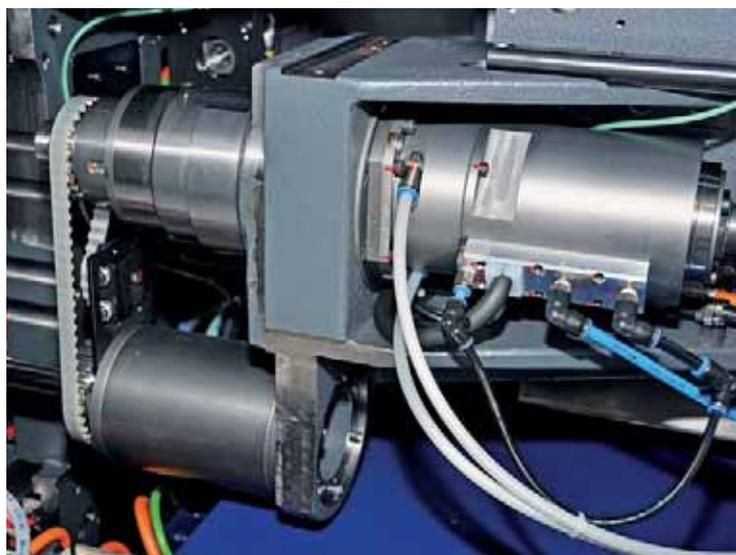
Con il suo performante design, il mandrino del motore sincrono installato è un importante fattore di riuscita. Da vedere: i due circuiti di alimentazione trasparenti per il raffreddamento dei mandrini.
