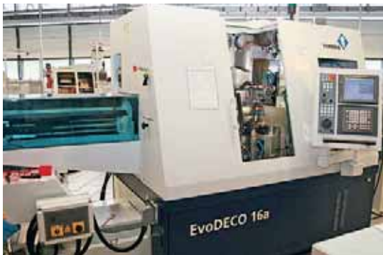
Den klart synliga fördjupningen ovanför bearbetningsområdet kan tillskrivas integreringen av denna del av höljet i skjutdörrarna. En egenskap som är högt uppskattad av svarvoperatörerna.
