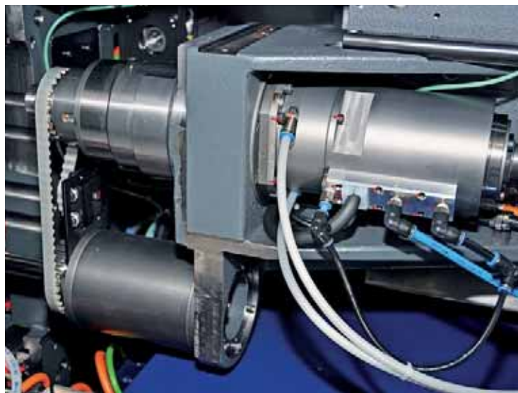
Konstruerad för hög prestanda är den synkrona motordrivna spindeln en viktig faktor för framgång. Lätt att se: de två transparenta matarledningarna för spindlarnas kylvätska.
