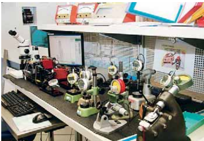
Svarvoperatörerna har åtkomst till en hel armada av mätinstrument i omedelbar närhet till maskinen för säker och effektiv test av kvaliteten på de svarvade detaljerna.
