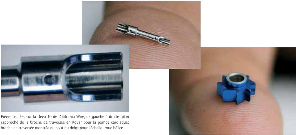
Pièces usinées sur la Deco 10 de California Wire, de gauche à droite: plan rapproché de la broche de traversée en Kovar pour la pompe cardiaque; broche de traversée montrée au bout du doigt pour l'échelle; roue hélice.
