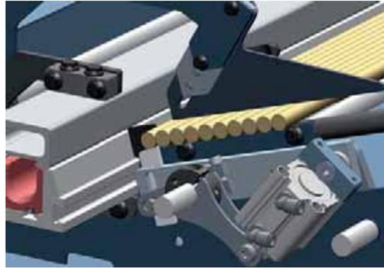
diamètre de broche de 12 mm. Un chargement par vis permet d'éviter les chevauchements des barres de petits diamètres. L'introduction dans le guide à la sortie des vis est accompagnée par un mouvement mécanique.
