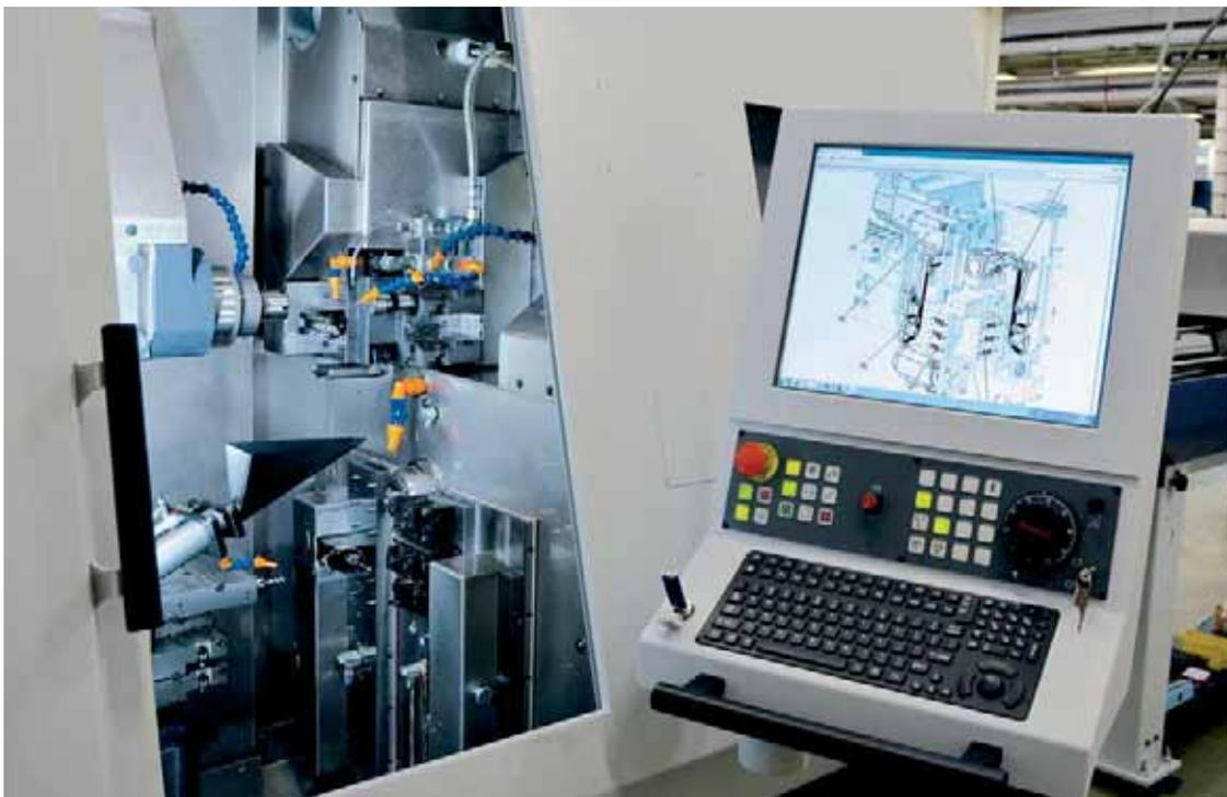
Le PC intégré dans la machine n'est pas nouveau chez Tornos puisque dès 2008, les machines MultiAlpha proposaient cette solution. Le PC reste donc dissocié de la commande numérique, mais la liaison entre les deux est extrêmement rapide. Par rapport à MultiAlpha, les machines EvoDeco disposent d'un écran tactile plus réactif et d'une puissance de calcul plus importante.
