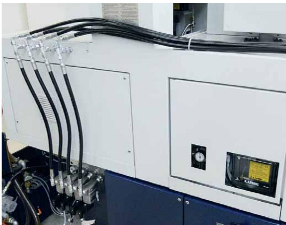
Le macchine Gamma sono di base provviste di una pompa di lubrificazione con una pressione da 3 bar. E' possibile aggiungere una pompa da 60 o da 120 bar. Una tubazione, sulla parte posteriore della macchina, collega le lubrificazioni standard tramite un semplice raccordo a T e, a seconda della pressione, una o l'altra delle due pompe entrerà in funzione.
