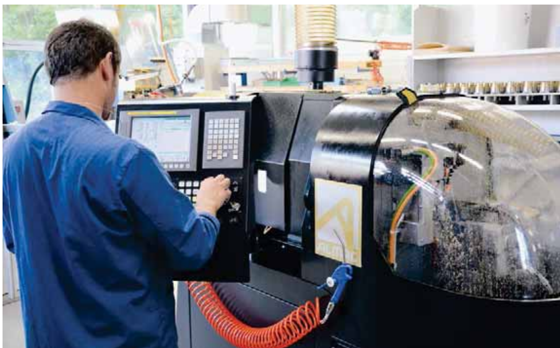
La BA 1008 est reliée au système centralisé d'aspiration des brouillards d'huile de Metalem.
