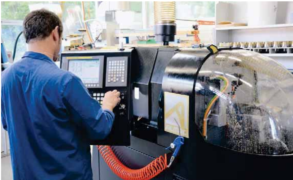
BA 1008 är ansluten till Metalems centrala oljedimutsugsystem.
