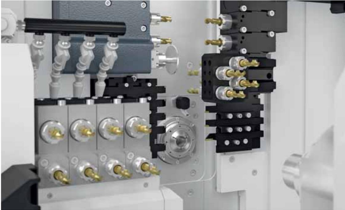
función de las piezas que se deben mecanizar. El contrahusillo está montado en un carro de correderas cruzadas y permite realizar las contraoperaciones en tiempos simultáneos al 100%.
