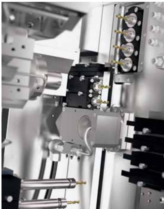
As máquinas podem ser equipadas com ferramentas de torneamento e com fresas em todas as posições disponíveis. São as únicas máquina do mercado que podem conseguir tal força de torneamento! Cada máquina pode receber diferentes porta-ferramentas especiais, dois turbilhoadores, aparelhos de corte, um poligonador e brocas de alta frequência. Embora parecidas, ambas as EvoDeco possuem características próprias.
