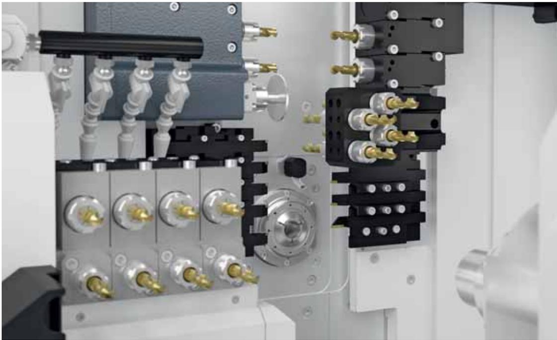
O contrafuso é montado sobre um chariot com rolamentos cruzados e permite realizar as operações reversas 100% em tempo oculto.
