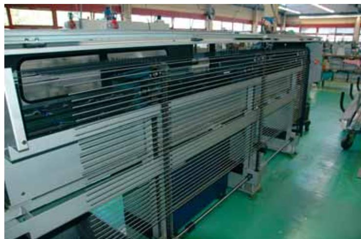
La carga de los seis husillos se realiza de forma totalmente automática mediante el cargador de barras Robobar MSF 316. Esto permite continuar la producción con eficacia incluso en turnos de trabajo sin personal.
