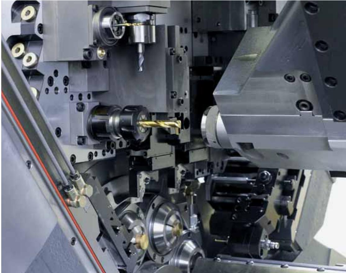
Con los dos contrahusillos montados cada uno en un eje se pueden tomar las piezas después del tronzo y mecanizar la parte posterior (tornear, taladrar, fresar, etc.).
