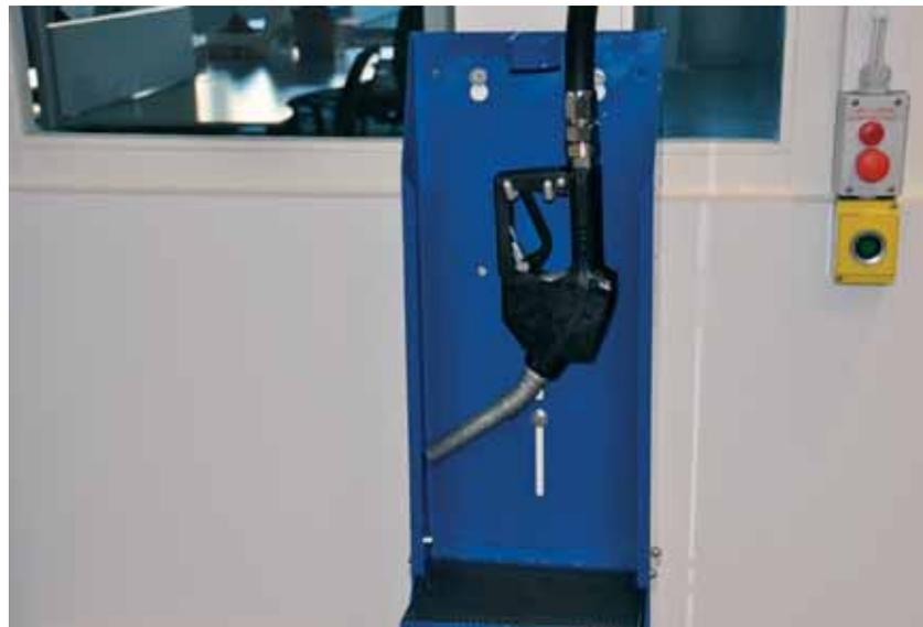
Naturalmente, en Stryker Spine los fluidos de mecanización se encuentran depositados en una posición central y se extraen mediante pistolas situadas directamente al lado del centro de mecanizado. En cada máquina se comprueba regularmente el estado de la taladrina.
