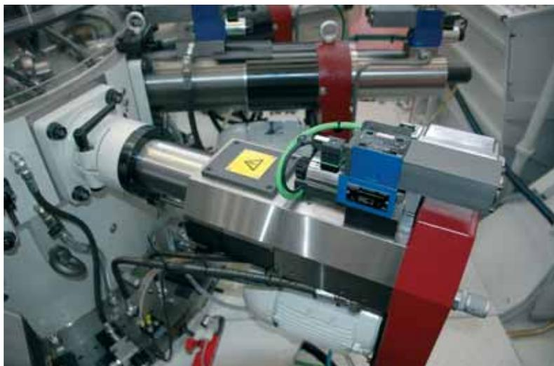
En las transfer rotativas de K.R. Pfiffner AG se utilizan hasta 16 de estas estaciones de mecanizado electrohidráulicas. La rotación se genera eléctricamente, mientras que los movimientos longitudinales y transversales son generados hidráulicamente.
