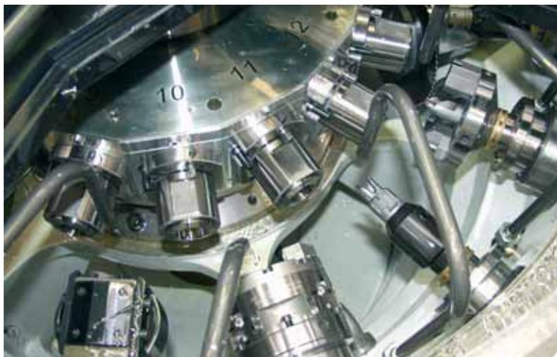
Así es: en la parte inferior de los soportes de pieza de las estaciones 10 a 13 y en el lado opuesto se encuentran las diferentes herramientas, que rotan durante el mecanizado y se desplazan tanto en el eje longitudinal como en el transversal.
