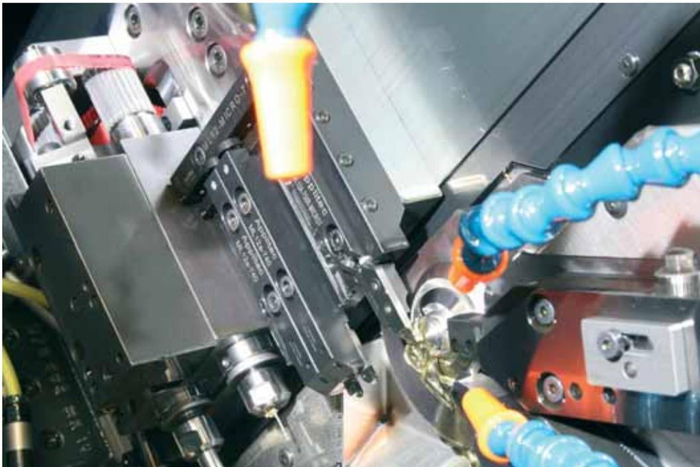
Vistazo al sistema de herramientas Modu-Line instalado en una de las Micro 7.
