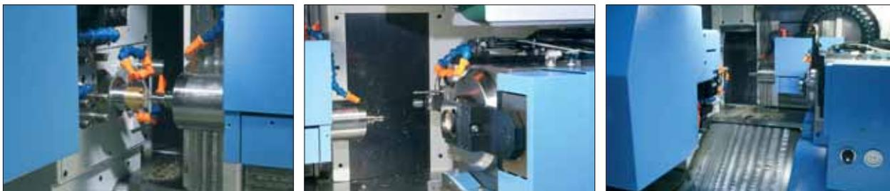
Vistazo del husillo principal: la máquina está preparada para mecanizar la cara uno de una nueva platina directamente en la barra. El contrahusillo espera una platina para mecanizarla en la cara dos...que va a buscar directamente en el husillo principal.
