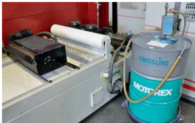
Con el absorbedor de aceite de banda, se «evacua» el aceite de fuga y, a través del filtro de banda, se extraen las virutas o partículas de metal más finas. El compacto mezclador de lubricante refrigerante aparece bien visible en el bidón móvil de Motorex.
