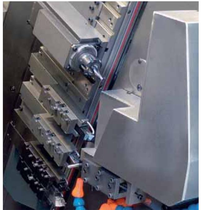
herramientas capaces de accionar tres herramientas de forma simultánea en el material.
