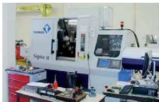
La máquina Sigma 32 de Tornos está vinculada de forma permanente a los dispositivos de medición y control, de modo que todas las operaciones se analizan en detalle.
