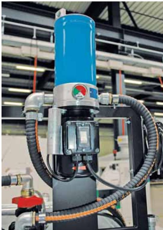
Lors du pompage de purge de la machine, l'huile de coupe est épurée avec une tolérance de 3 microns grâce à un filtre intégré hautement efficace. Ceci permet de garantir un degré de pureté optimal du fluide d'usinage dans le réservoir d'huile usagée.
