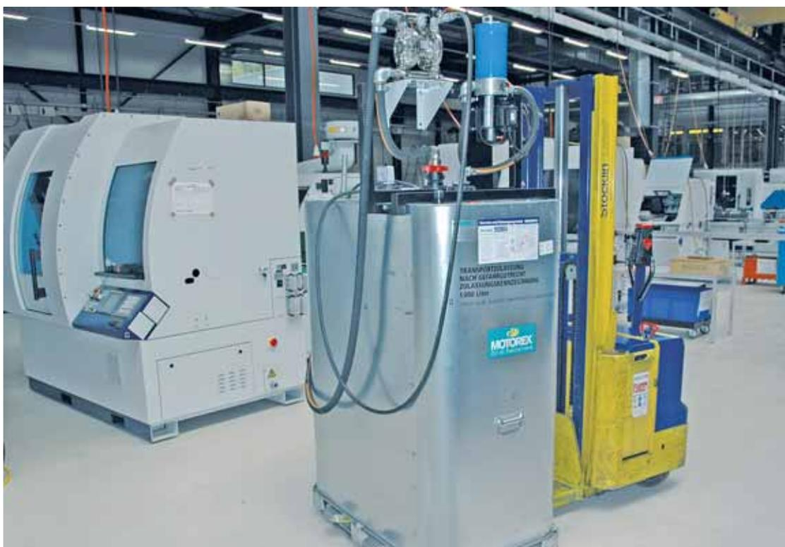
Plusieurs réservoirs à double paroi de ce type servent au remplissage et au vidage des machines. Ils peuvent être transportés comme des palettes et chacun d'entre eux est équipé d'une pompe et d'une unité de filtrage.
