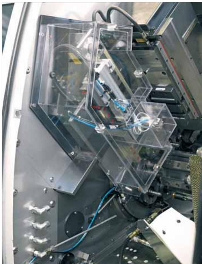
Zone d'usinage montrant le système de chargement. Chaque projet est spécifique en fonction des pièces à réaliser. Dans cet exemple la mise en place de la pièce dans de la contre-broche se fait à l'aide d'une pince manipulatrice.
