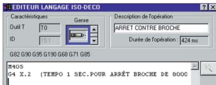
3. Modification dans l'opération 15 : 2 de la tempo G4 X1 par G4 X.75, ce qui donnera un temps total d'arrêt 976 ms à la contre-broche pour se remettre en rotation. Dans ce cas, on peut l'adapter à chaque pièce car il s'agit d'un temps en grande partie masqué.
