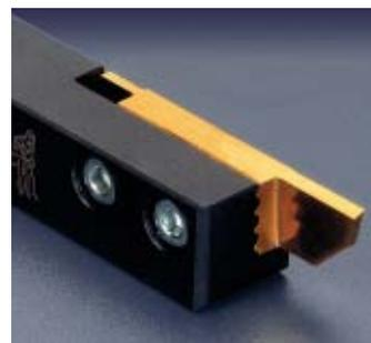
APPLITEC propose sur la plupart de ses outils de type 700 la possibilité de serrage depuis le côté opposé de la plaquette, avec le même porte-outil. Deux petits inserts filetés sont alors ajoutés dans les plaquettes (serrage type B).
