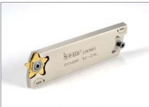
et de conditions d'usinage, d'où une excellente finition de surface des fonds et des parois latérales de rainures. De plus, la plaquette est montée tangentiellement et pressée contre deux surfaces de contact périphériques, afin d'assurer un ajustage précise en hauteur par rapport au plan de centre.
