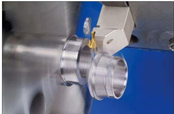
présent être rectifiées de façon parfaitement adaptée aux besoins de l'utilisateur. Ainsi, le PENTACUT est désormais à même de reproduire le contour de son arête de coupe sur le profil de révolution extérieur de la pièce en vue de générer une multitude de formes et de profils complexes.
