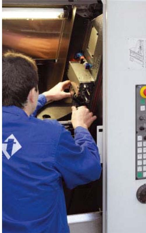
Bien que le nombre d'outils soit différent, les mêmes opérations peuvent être effectuées soit sur la broche principale, soit sur la contre-broche, qui sont de puissance égale. Il n'y a donc aucune limite dans la réalisation des opérations, ce qui permet à l'opérateur d'équilibrer au besoin les opérations sur les deux broches afin d'obtenir un gain de temps parfois important.
