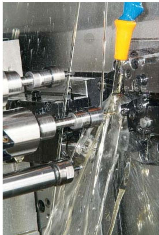
Vue intérieure d'une des machines DECO – en haut le très utile appareil de fraisage polygonal.
