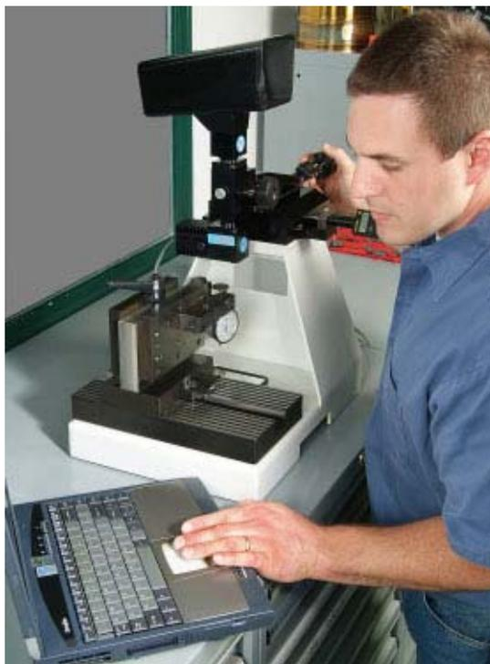
Tornos fournit un banc de pré-réglage avec ses DECO pour assurer le réglage des outils pour la série suivante pendant que les machines continuent de produire.
