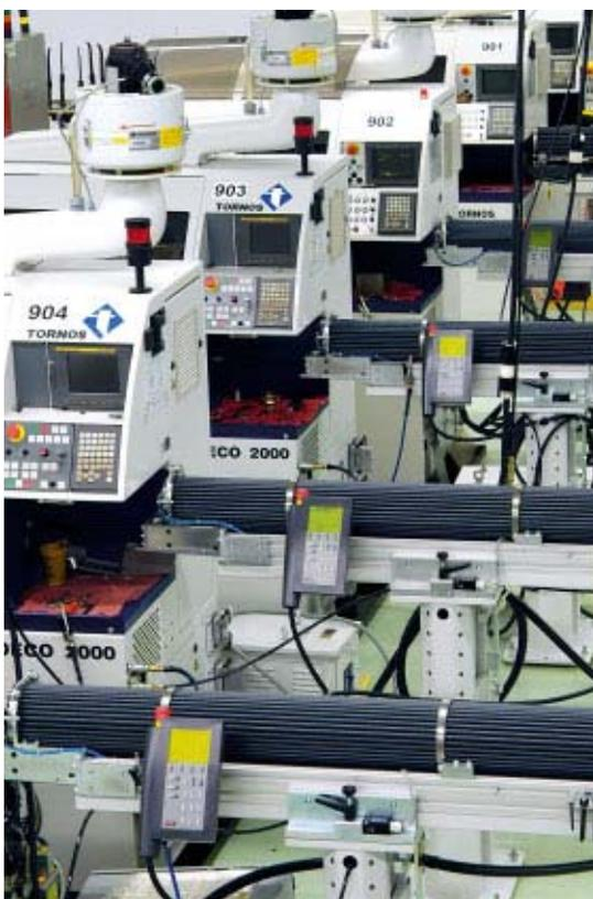
L'entreprise possède huit machines 9-axes Tornos DECO 10 mm pour réaliser des opérations multiples compliquées en un seul passage en machine, la capacité de réaliser des opérations de fraisage polygonal étant un de leurs atouts majeurs.
