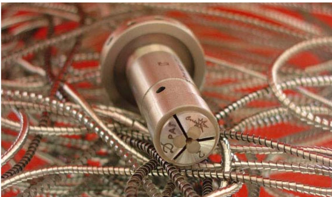
Le système de canon de guidage MAGIC soigneusement étudié de la maison Walter Dünner SA permet l'ouverture et la fermeture entièrement automatiques du canon. Lorsqu'une barre est usinée au point qu'il n'en reste plus qu'un petit bout, l'expulsion de ce dernier du canon en est simplifiée. Une fois la nouvelle barre introduite, le canon de guidage MAGIC s'ajuste automatiquement à la valeur prédéfinie!
