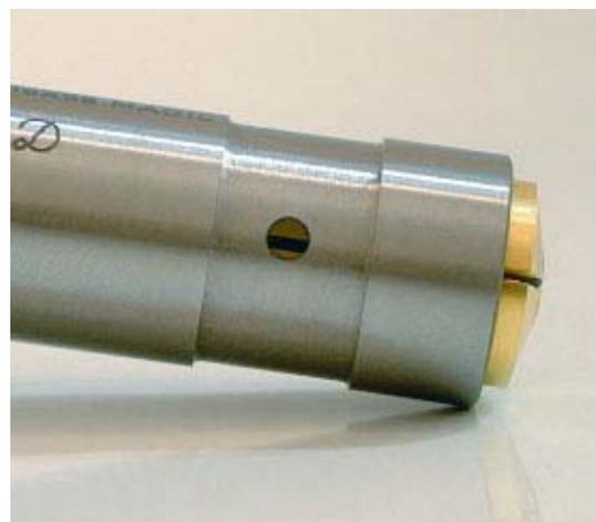
Sur demande, des canalisations d'huile supplémentaires latérales peuvent être aménagées sur la plupart des canons de guidage. Ainsi, le lubrifiant peut agir en quantité suffisante pour graisser et refroidir les emplacements critiques. Quelques fournisseurs aménagent de série des perçages latéraux sur leurs produits.
