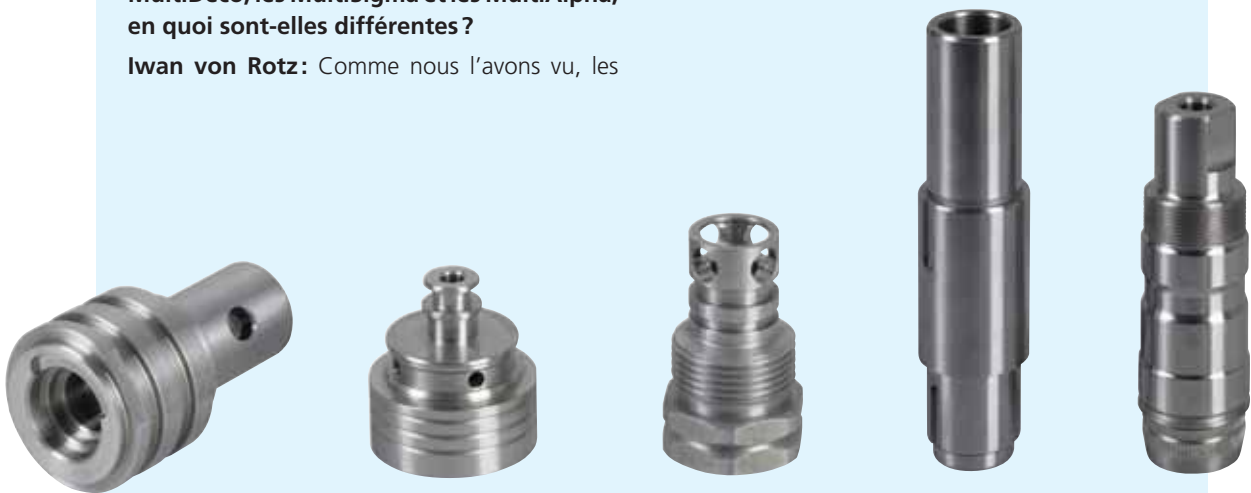
Ce type de pièce est désormais à la portée d'un tour multibroche. Même les opérations de tourbillonnage y sont possibles !
