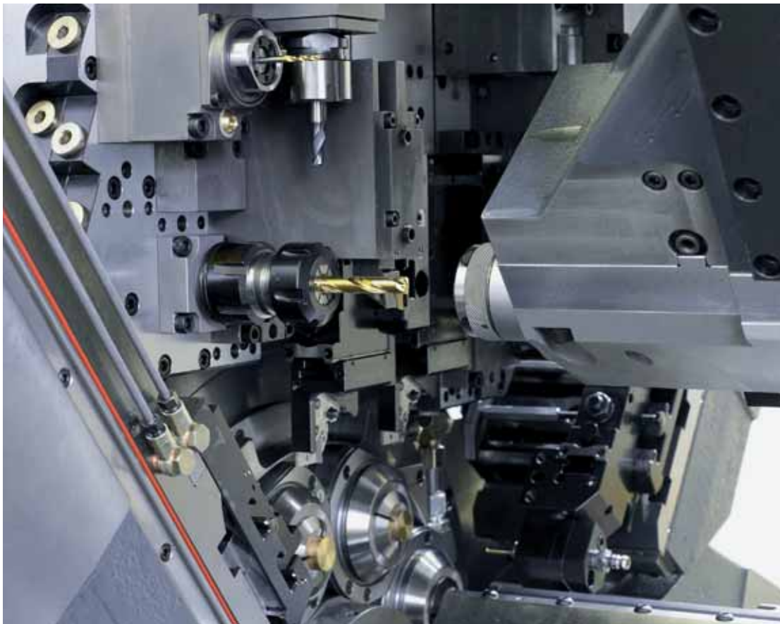
Les deux contre-broches montées chacune sur un axe peuvent saisir les pièces après le tronçonnage et les usiner sur leur face arrière (tournage, perçage, fraisage, etc.).
