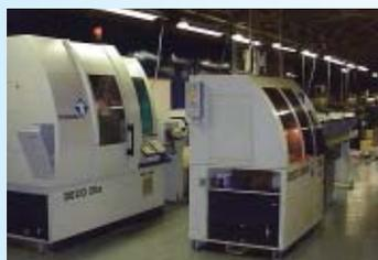
TORNOS DECO 20a, portant à quatre le nombre de machines CNC. La grandeur des séries varie de 10 à 10'000 et jusqu'au-delà du million de pièces.
