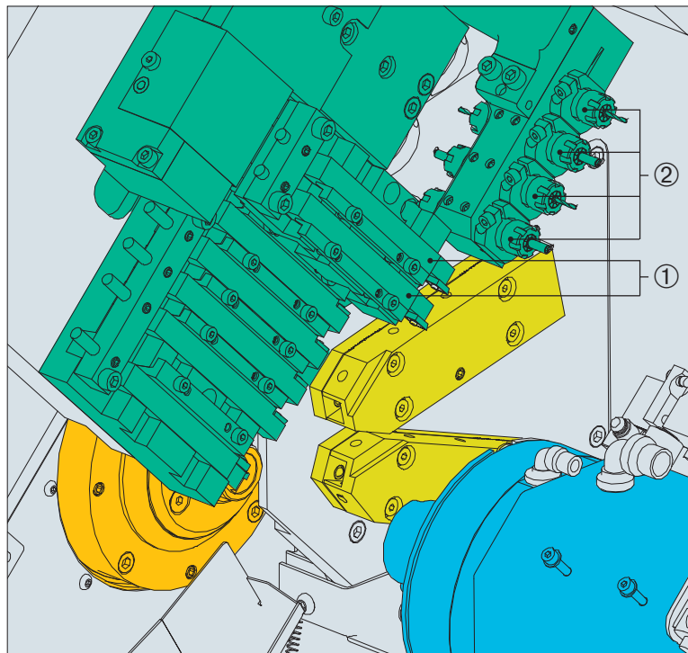
Les positions pour l'accueil des outils en contre-opération servent également à la pose d'un perceur transversal. Pos. ① Les cylindres avec les porte-outils d'Applitec sont glissés dans les logements pour les outils de perçage en contre-opération. Pos. ②
