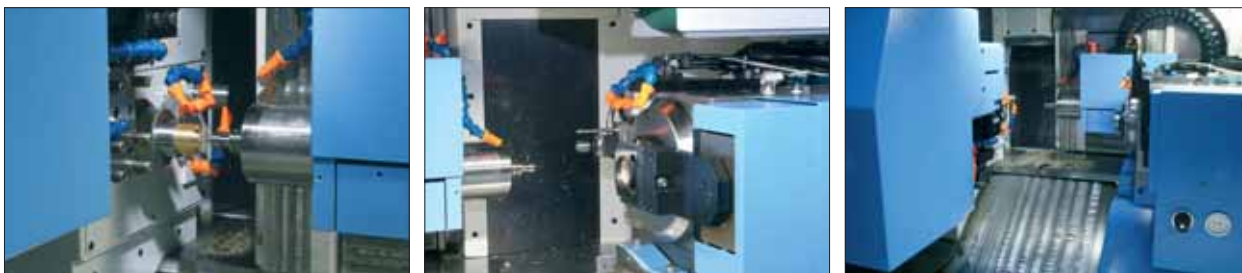
Regard sur la broche principale: la machine est prête à usiner la face d'une nouvelle platine directement sur la barre. La contre-broche attend une platine pour l'usiner sur la face deux... ...qu'elle va chercher directement sur la broche principale.
