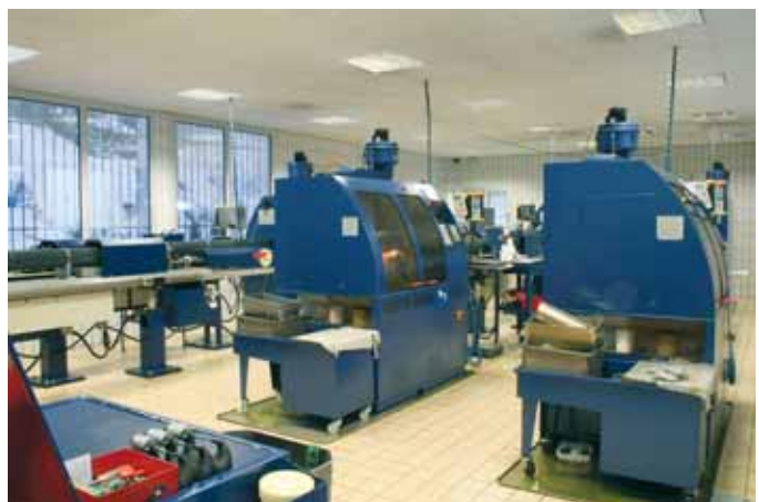
Une des salles de machines avec des tours automatiques DECO 2000. Ici également règne une propreté rigoureuse.
