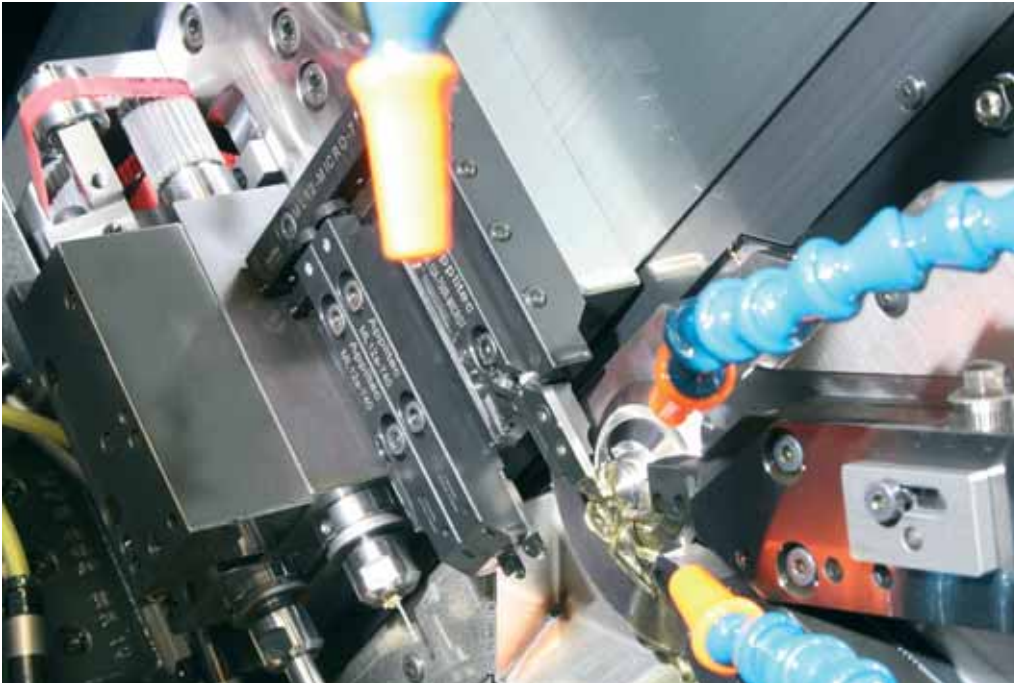
Regard sur le système d'outillage Modu-Line installé dans une des Micro 7.
