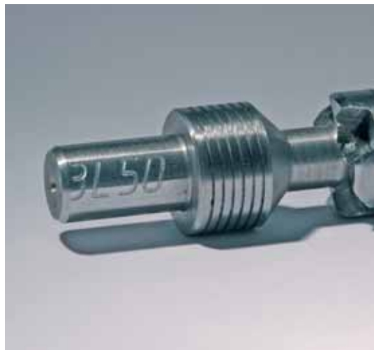
Détail d'une inscription programmée avec Millwriter et gravée sur le tour.
