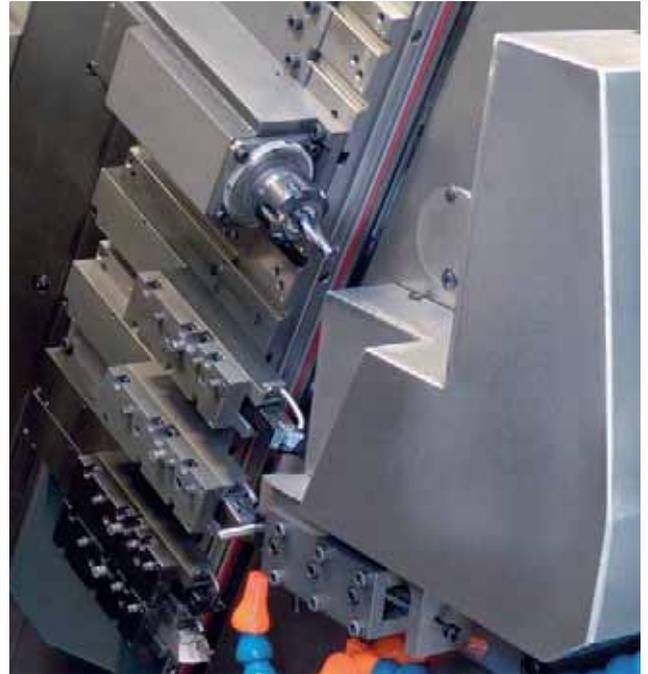
capacités sont encore renforcées par l'adjonction d'un outil ébaucheur au canon. Ainsi, la machine est la seule du marché dotée de deux systèmes d'outils capable d'engager trois outils simultanément dans la matière.
