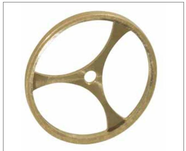
Il est désormais possible de réaliser entièrement ce type de pièces sur un tour automatique équipé de broches à haute fréquence. Le fait de ne pas avoir à reprendre la pièce sur un autre moyen de production est synonyme de taux de rebus drastiquement réduits.
