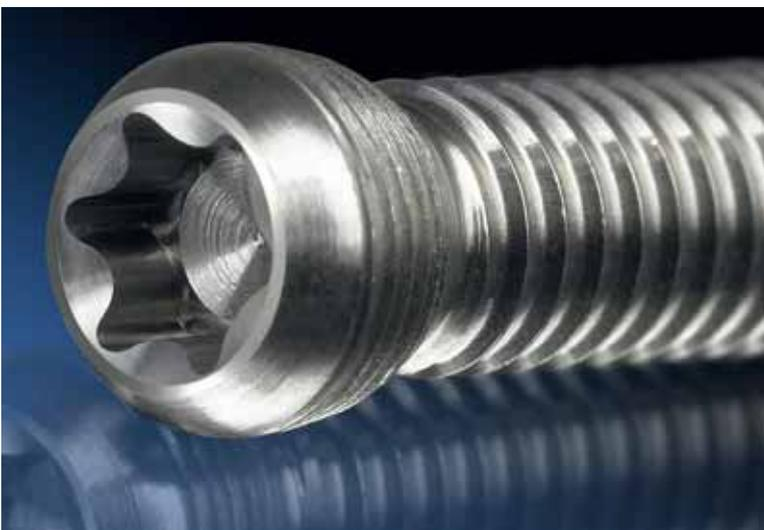
Les vis à têtes Torx sont de plus en plus utilisées, notamment dans le médical à cause de leur meilleure résistance lors du serrage de la vis. Le fraisage du profil à l'aide d'une broche à haute fréquence supprime les contraintes liées à la technologie du brochage (espace pour les copeaux au fond du pré-perçage et efforts subis par la pièce et la machine notamment) tout en réalisant des pièces d'une qualité constante et élevée.
