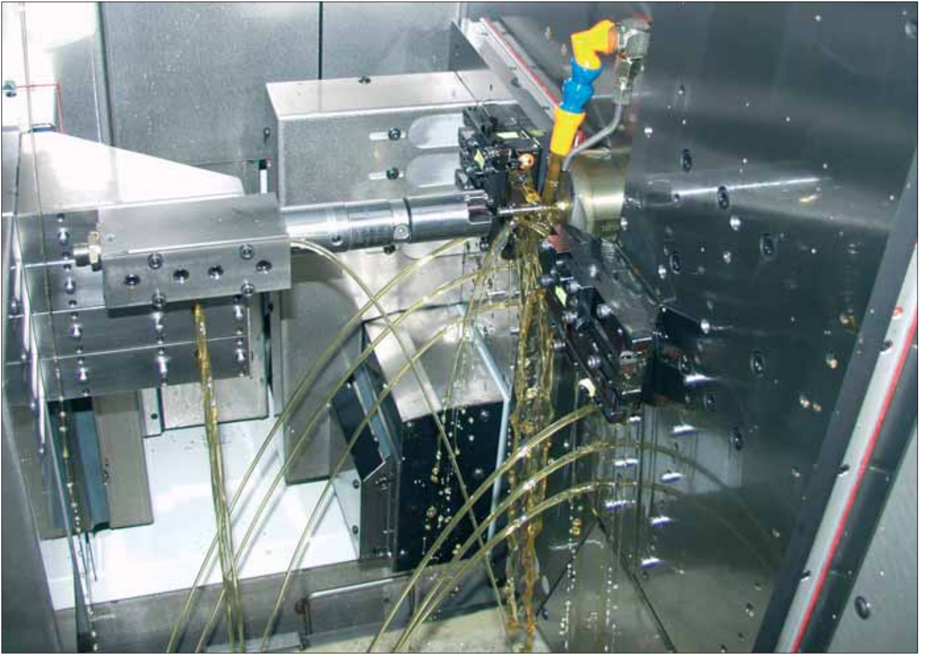
Le but consiste à créer de manière tribologique un coussin d'huile stable sur la lame de coupe. (Photo: Motorex)
