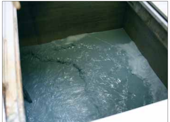
En mélangeant intensivement les émulsions usées avec un agent séparateur, l'émulseur perd son efficacité, eau et huile se séparent plus facilement.
