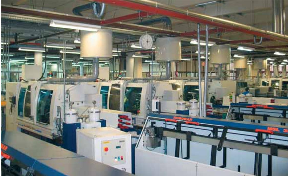
La dizaine de machines multibroches CNC MULTIDECO permet à l'atelier Joseph Martin SA de produire des séries de 30 à 50'000 pièces le plus rationnellement possible.
