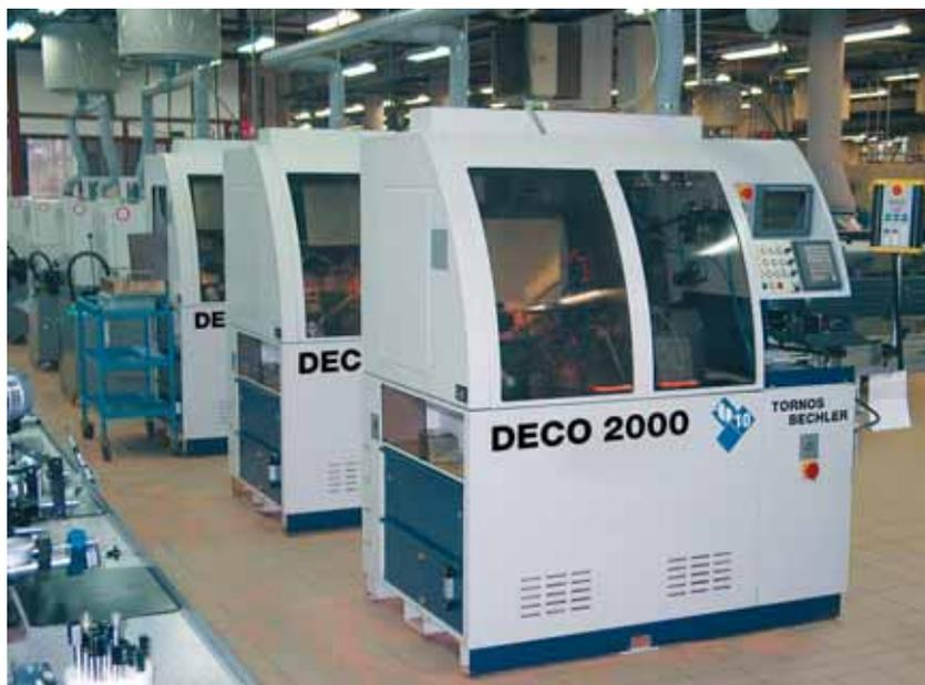
Atelier des DECO. Comme pour les multibroches, chaque machine est reliée au système centralisé de purification de l'air.
