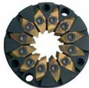
Sans augmenter l'avance par dent, le nombre de dents fait le rendement de l'outil. Comparé à une tête de  $z=3$  et une avance de 0.02 [mm/z], nous obtenons une augmentation de 200% du rendement pour une tête de  $z=9$  ou de 300% pour une tête de  $z=12$ .
