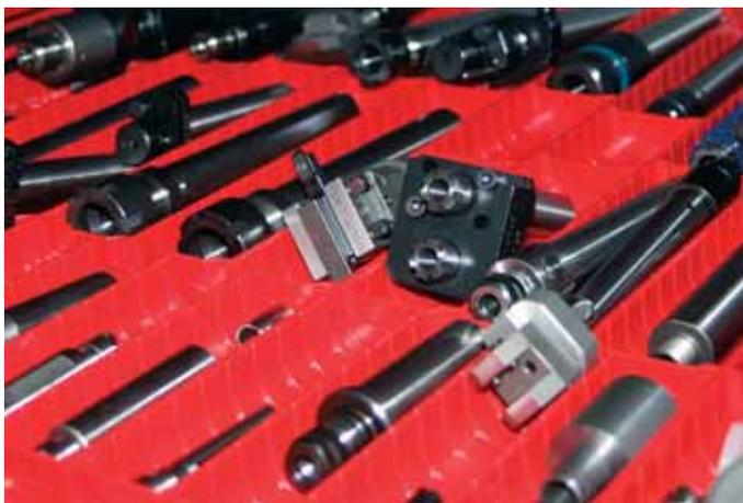
Tournage – fraisage – perçage – tourbillonnage – gravage et encore bien plus, le tout sur une seule et même machine. En outre, Josef Ganter Feinmechanik dispose de toute une gamme d'outils spéciaux et d'embases qui rendent ses machines Tornos encore plus polyvalentes.
