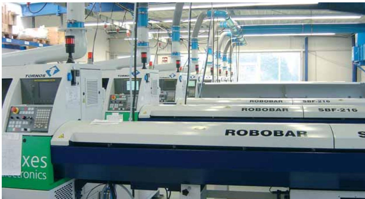
Les huit tours automatiques monobroches CNC Tornos bien alignés dans le hall de construction moderne de Conec.
