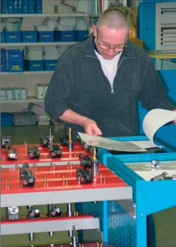
Préparation du matériel à l'avance pour la réalisation d'une nouvelle série, l'arrêt machine est réduit au minimum.
