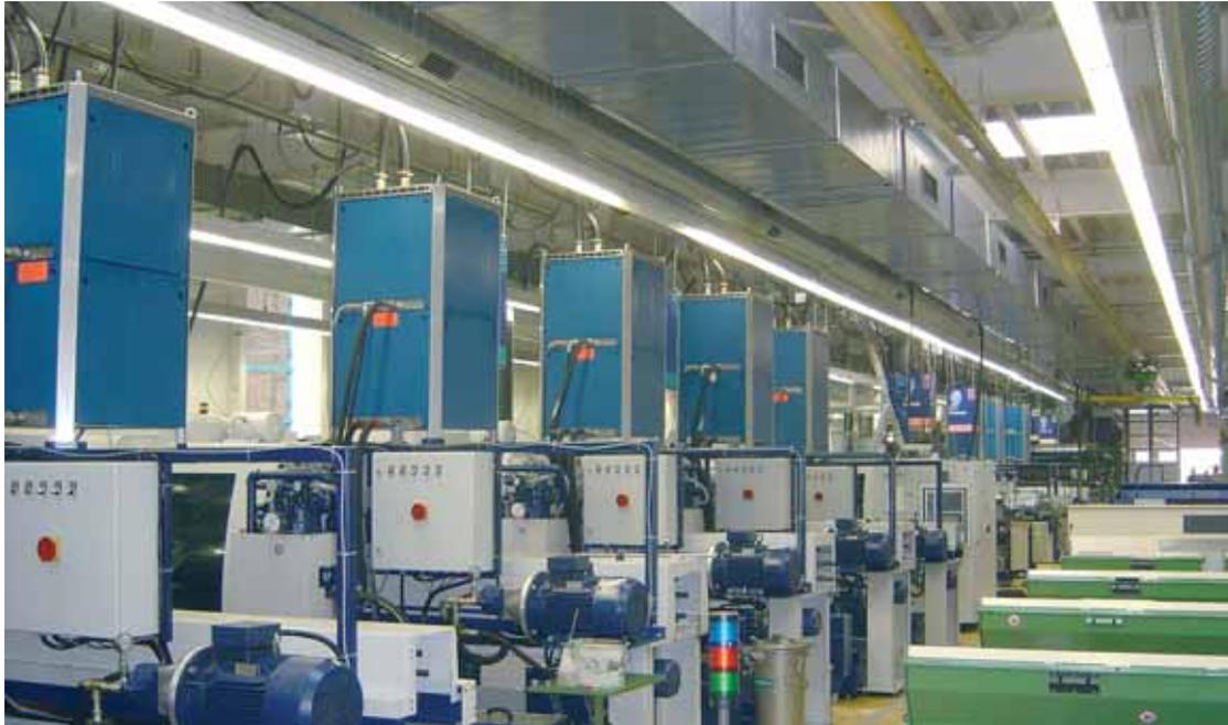
Toutes les machines sont raccordées à une installation d'aspiration centrale et fonctionnent quasiment en continu de manière fiable.
