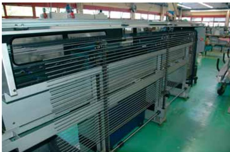
Les six broches sont automatiquement alimentées par le ravitailleur de type Robobar MSF 316. Une production efficace et illimitée est ainsi garantie même lors des équipes entièrement robotisées.
