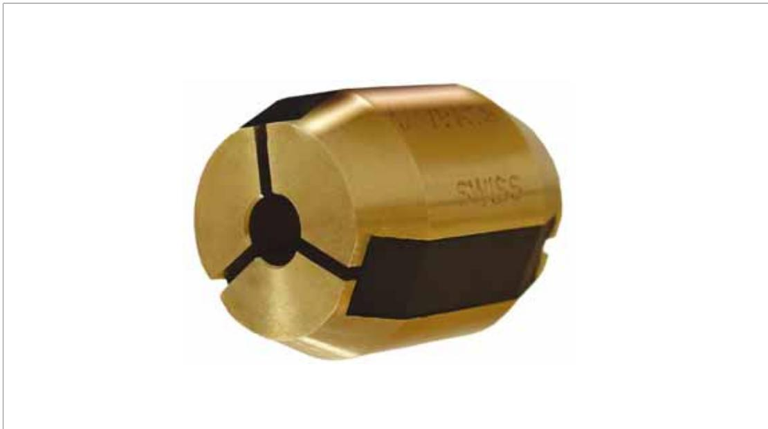
*une grande force de serrage et assez étanche pour éviter que les copeaux n'envahissent la douille de serrage. La précision de la pince vient du fait que nous utilisons le cône de la douille comme référence et la face de l'écrou de serrage, ce qui met en ligne la pince dans le logement. La gomme vulcanisée dans les fentes donne la force d'ouverture et remplace ainsi le ressort.» D. Dünner.*
