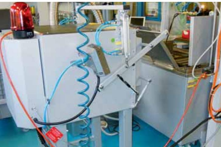
Installation de trempes permettant la réalisation de petites séries de pinces rationnellement.
