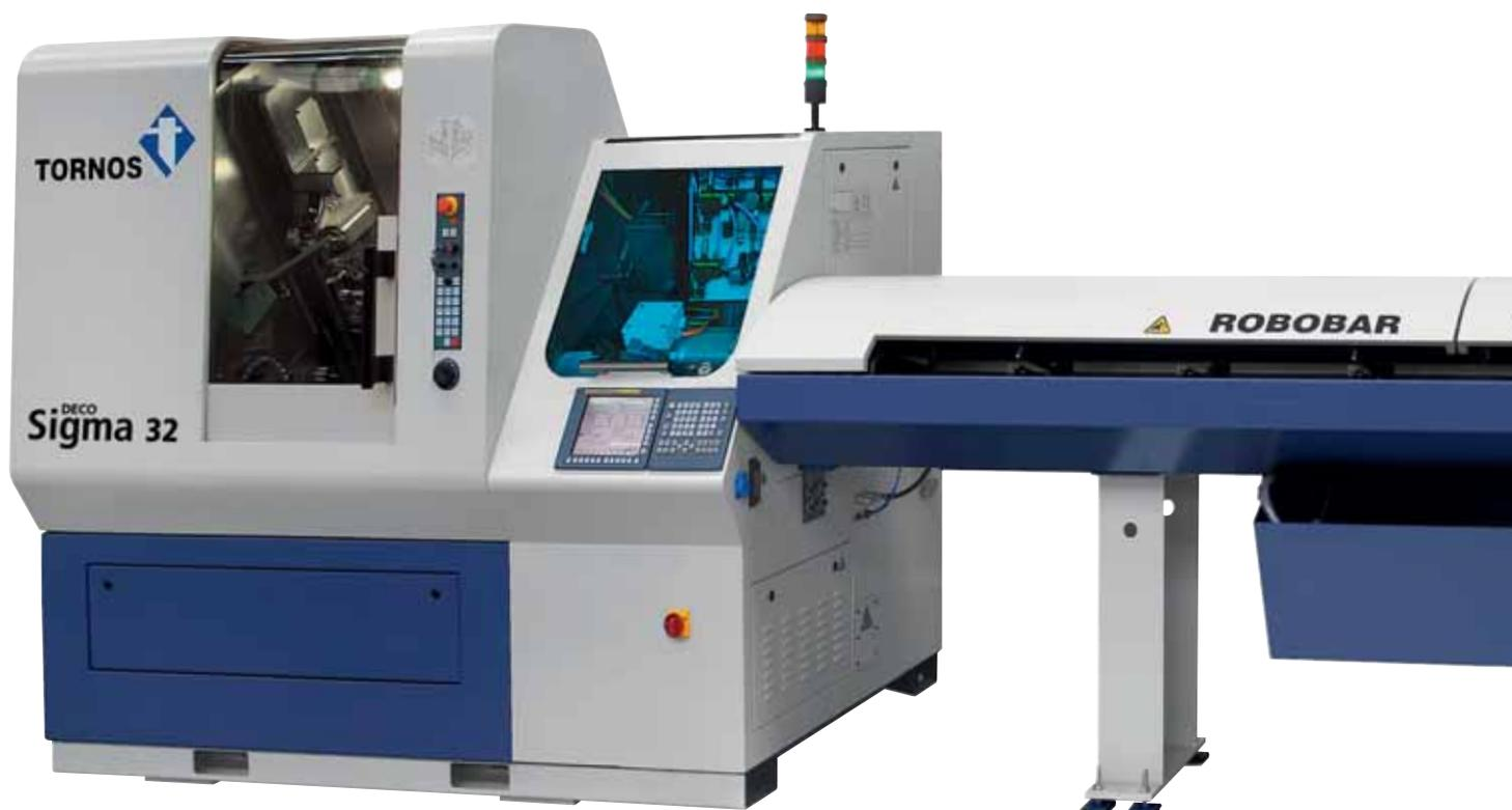
Tornos conçoit et fabrique 90 pour cent des éléments des machines. La conception globale de la machine est basée sur la méthode des éléments finis (FEM), pour une optimisation de l'agencement des axes et de la conception des divers éléments constitutifs.
