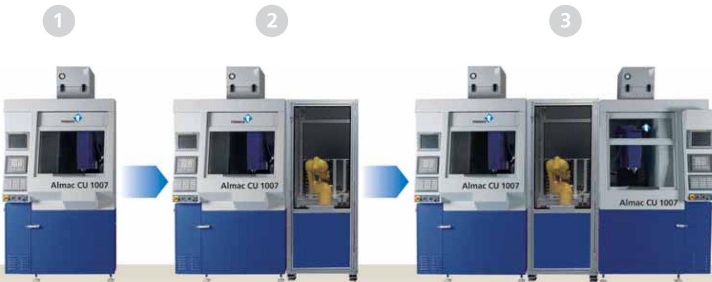
Soumis à des contraintes d'augmentation de production, l'utilisateur peut sans autre ajouter le système de palettisation et de robotisation (2). Plus tard, ou simultanément, il dispose de la possibilité d'ajouter un autre centre CU 1007 (3) et de «partager» le robot.
