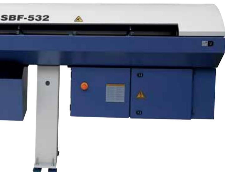
Tornos propose ses machines avec ses propres ravitailleurs de barres sous forme de solutions d'usinage complètes. Ainsi, il est possible d'équiper le modèle Sigma 32 avec le ravitailleur Robobar SBF-532.
