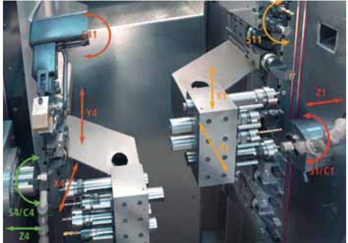
La capacité maximale de la machine est de 22 outils. Tous les outils peuvent être mis en œuvre, sur la broche principale comme sur la contre-broche. La broche principale et la contre-broche disposent de la même puissance d'entraînement, pour une optimisation des opérations.
