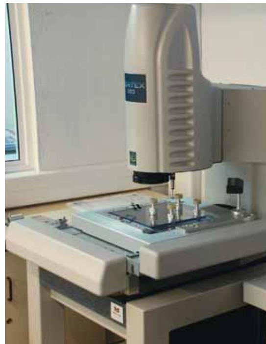
L'entreprise dispose d'une salle grise et d'un système de vision et de palpé 3D.
