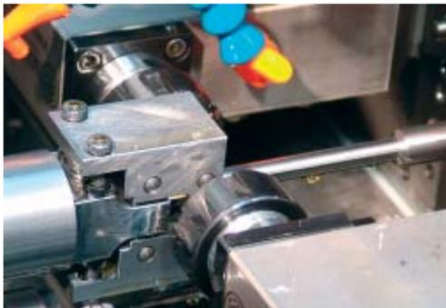
Fresatura dell'esagono esterno con 2 utensili simultaneamente e supporto del particolare all'inizio.
