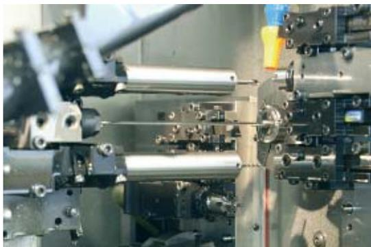
Per poter realizzare delle forature profonde su un centro di lavorazione, quale ad esempio una TORNOS DECO 20a, sono necessari un dispositivo di foratura profonda ed un performante sistema di lubrificazione ad alta pressione. In fase di foratura profonda di acciai altamente legati ed inossidabili, come quelli utilizzati nel settore medico-tecnico, il fluido di lavorazione sotto altissima pressione espelle, man mano che si producono, i trucioli presenti nel foro cieco.
