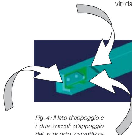
Fig. 4: Il lato d'appoggio e i due zoccoli d'appoggio del supporto garantiscono una perfetta perpendicolarità della plachetta sul suo supporto.
