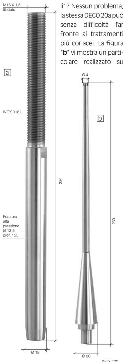
DECO 20a con passo da 4 mm al raggio, tornitura sbozzo finitura in simultanea. Per quanto riguarda il particolare "a" esso comporta un rollatura del filetto M16 e una foratura interna diametro 13,5, profondità 155 mm. Questi due particolari illustrano perfettamente la grandissima stabilità della macchina.
