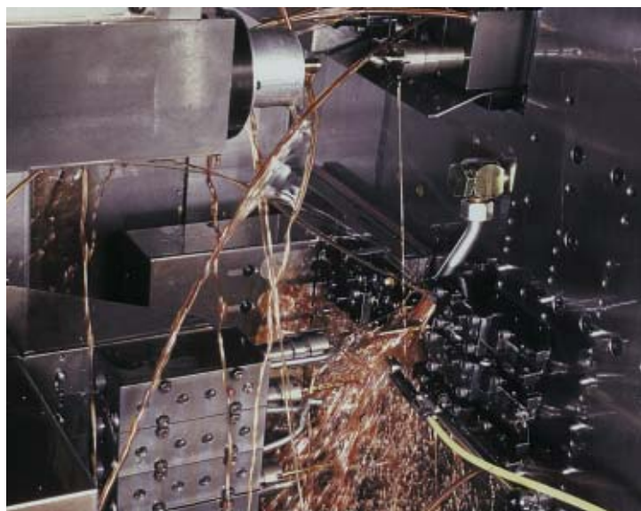
I particolari sono lavorati simultaneamente sui mandrini superiore e inferiore della DECO 2000 e numerose operazioni di lavorazione sono parimenti effettuate allo stesso tempo, eliminando praticamente tutti i tempi morti e migliorando considerevolmente la produttività.
