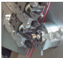
Lavorazione alla bussola Tornitura
