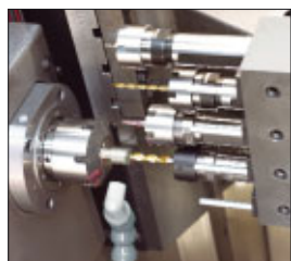
Lavorazione in contro-operazioni Foratura in punta
