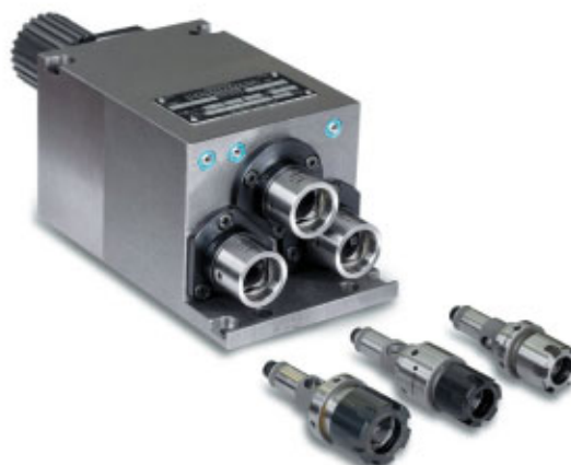
Apparecchio a 3 mandrini girevoli con tasselli amovibili. Il decalaggio laterale dei mandrini permette di utilizzare, su uno stesso apparecchio, delle frese/punte per operazioni trasversali nonché una fresa-segatrice in posizione superiore (decalaggio)
