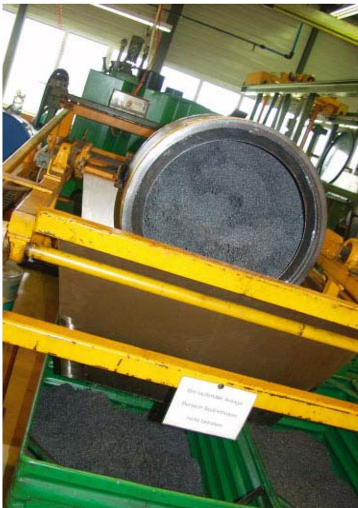
*Se si aggiungono le superfici di tutti i trucioli, si ottengono delle superfici incredibilmente elevate. I trucioli devono quindi in primo luogo essere centrifugati efficacemente dopo di che l'olio deve essere filtrato il più finemente possibile. Il risultato?: trucioli quasi "asciutti" !*
