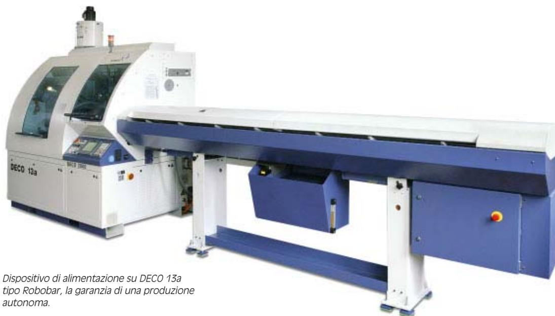
Dispositivo di alimentazione su DECO 13a tipo Robobar, la garanzia di una produzione autonoma.
