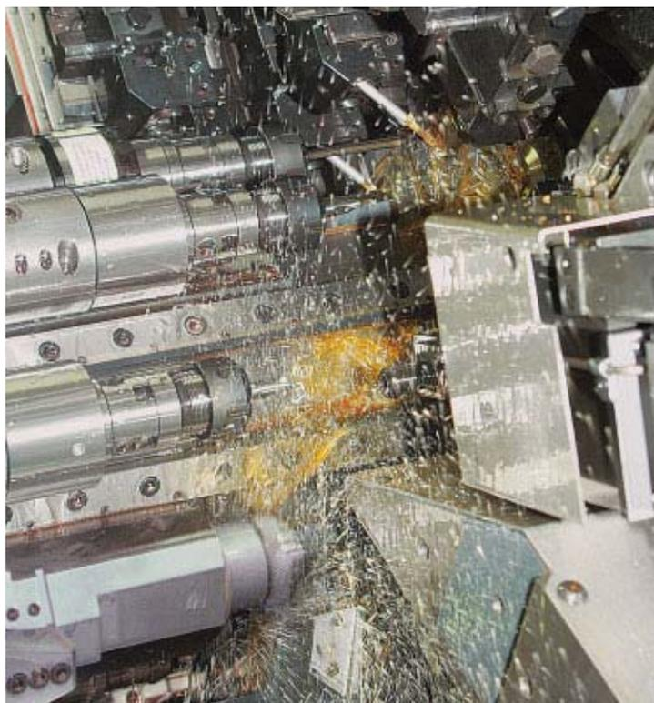
*Otto in azione: sulla MULTIDECO 20/8d, 8 mandrini con velocità di rotazione indipendenti sono messi in opera simultaneamente. La produttività per i particolari complessi è aumentata di una doppia potenza! A seconda dell'entità dell'ordine, può valer la pena di prendere in considerazione l'acquisto di un tornio automatico multiman-drino.*
